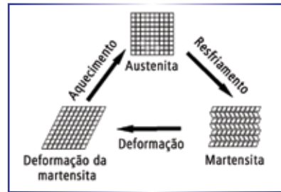
Fig. 3 – Mecanismos da memória de forma do NiTi (Fernandes, 2006)
