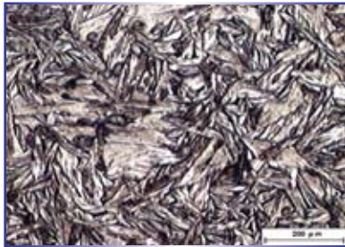
Fig. 10 – Metalografia da chapa de NiTi (aumento: 50 x; ataque: 30 ml de ácido acético glacial, 5 ml de ácido nítrico e 2 ml de ácido fluorídrico)
